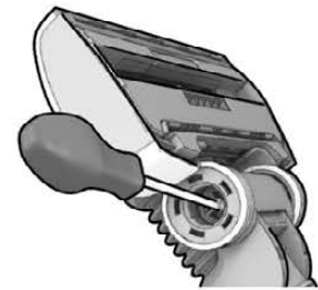
3. قم بترك محاور العجل ثم قم بتنظيف جميع الأجزاء الخاصة بالعجل. بعد الانتهاء من عملية التنظيف قم بإعادة التركيب.
