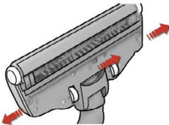
1. قم بالضغط على الزرين الجانبيين لفتح الغطاء الخاص بالفوهة. ثم قم بإزالة العجلات الامامية وابدأ بعملية التنظيف.
