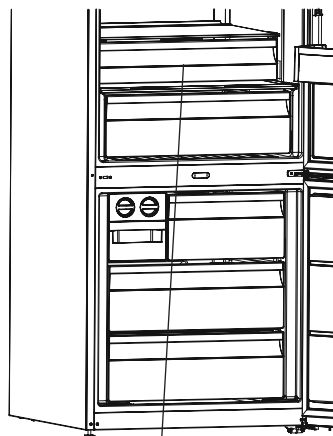
Comparto Chiller (zerogradi)
